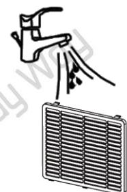
Βεβαιωθείτε ότι το πλαίσιο φίλτρου και το ενσωματωμένο πλενόμενο φίλτρο αέρα έχουν στεγνώσει τελείως πριν τα επανατοποθετήσετε στη συσκευή.
