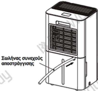
**Προσοχή:** Όταν πλέον δεν χρησιμοποιείτε τη λειτουργία συνεχούς αποστράγγισης, απομακρύνετε το σωλήνα από το στόμιο εξόδου νερού, τραβήξτε προς τα έξω το δοχείο νερού και επανατοποθετήστε το σωστά στη θέση του στη συσκευή ώστε να αποφευχθεί πιθανή διαρροή νερού από τη μονάδα σας λόγω μη σωστής τοποθέτησης του δοχείου. Επιπλέον, η μονάδα σας δεν θα μπορεί να λειτουργήσει αν το δοχείο νερού δεν είναι σωστά τοποθετημένο στη θέση του.
