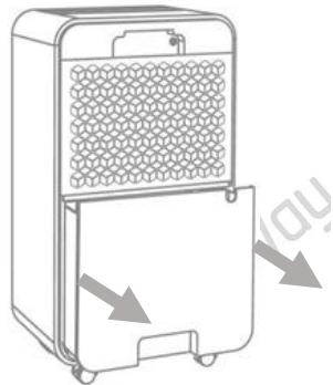
Αναποδογυρίστε και αδειάστε το δοχείο νερού, σκουπίστε την εξωτερική του επιφάνεια ώστε να είναι στεγνή και κατόπιν επανατοποθετήστε το μέσα στη θέση του στη συσκευή και σπρώξτε ελαφρά και με τα δύο χέρια σας ώστε να ασφαλίσει στη θέση του.
