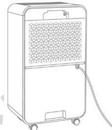
**Προσοχή:** Όταν πλέον δεν χρησιμοποιείτε τη λειτουργία συνεχούς αποστράγγισης, απομακρύνετε το σωλήνα από το στόμιο εξόδου νερού, τραβήξτε προς τα έξω το δοχείο νερού και επανατοποθετήστε το σωστά στη θέση του στη συσκευή ώστε να αποφευχθεί πιθανή διαρροή νερού από τη μονάδα σας λόγω μη σωστής τοποθέτησης του δοχείου. Επιπλέον, η μονάδα σας δεν θα μπορεί να λειτουργήσει αν το δοχείο νερού δεν είναι σωστά τοποθετημένο στη θέση του.
